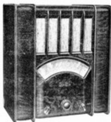
Saba 330 WLP einschließlich Röhren RM 235.— Dreikreis-Dreiröhren-Gerät, für Wechselstrom, ohne Kurzwele, Prefstoff-Gehäuse. Tonblende. Röhrensatz: 2/1284, 1/964, 1/1064 oder Valvo
