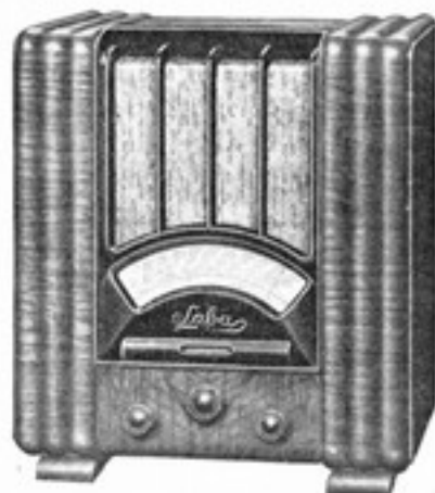
Saba 630 WLK einschließlich Röhren RM 322.50 Vierröhren-Super mit 7 Kreisen, hiervon 4 Zwischenfrequenzkreise, ein separater Oszillator, eine Duo-Diode als Hochfrequenz-Gleichrichter. Wertvolles Edelholzgehäuse, vollkommener Schwundausgleich, Wellenvisierlampe, sehr guter Kurzwellenteil. Röhrensatz: 2 RENS 1294, 1 REN 904, 1 RENS 1284, 1 RES 964, 1 AB 1, 1 RGN 1064 oder Valvo
