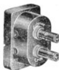
Nr. 104/23 . . . brutto RM 1,90 Diese Erdungsdose vereinigt Hebelschalter, Grob-Über- spannungsschutz und Funkdose. Sie erdet automatisch beim Herausziehen des Antennensteckers. Entspricht den VDE-Vorschriften.
