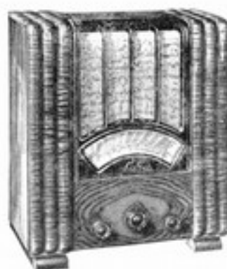
Saba 330 WLH einschließlich Röhren RM 245.— Dreikreis-Dreiröhren-Gerät, für Wechselstrom, ohne Kurzwele, Holz-Gehäuse. Tonblende. Röhrensatz: 2/1284, 1/964, 1/1064 oder Valvo
